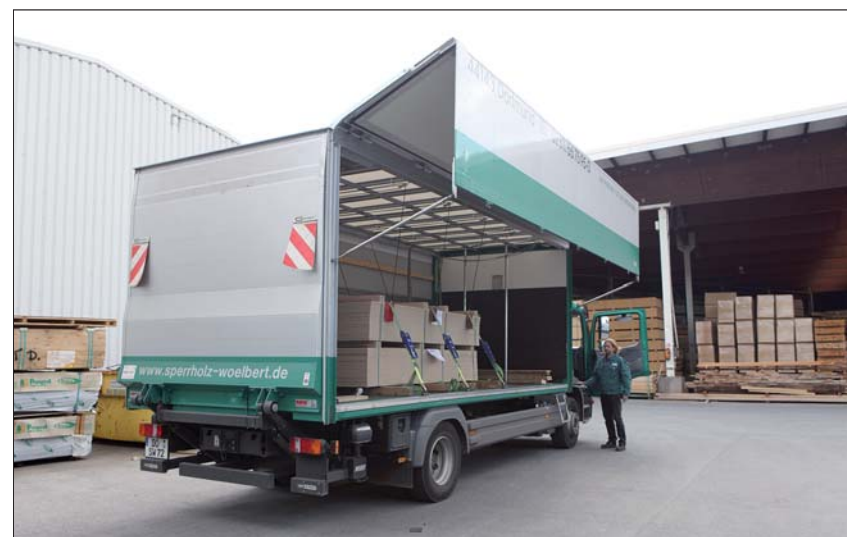
Der neue Wingliner des Unternehmens verkürzt das Be- und Entladen
